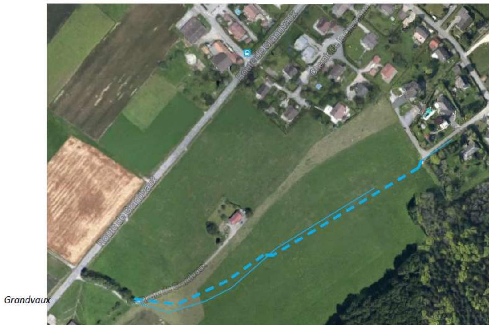
— Tracé du collecteur EC projeté (remplacement) PP diam. 500 mm
